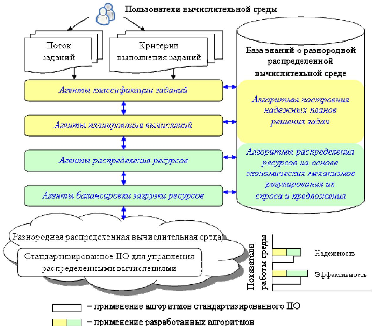
Рис. 8. Схема управления распределенными вычислениями в интегрированной кластерной системе ИДСТУ СО РАН
