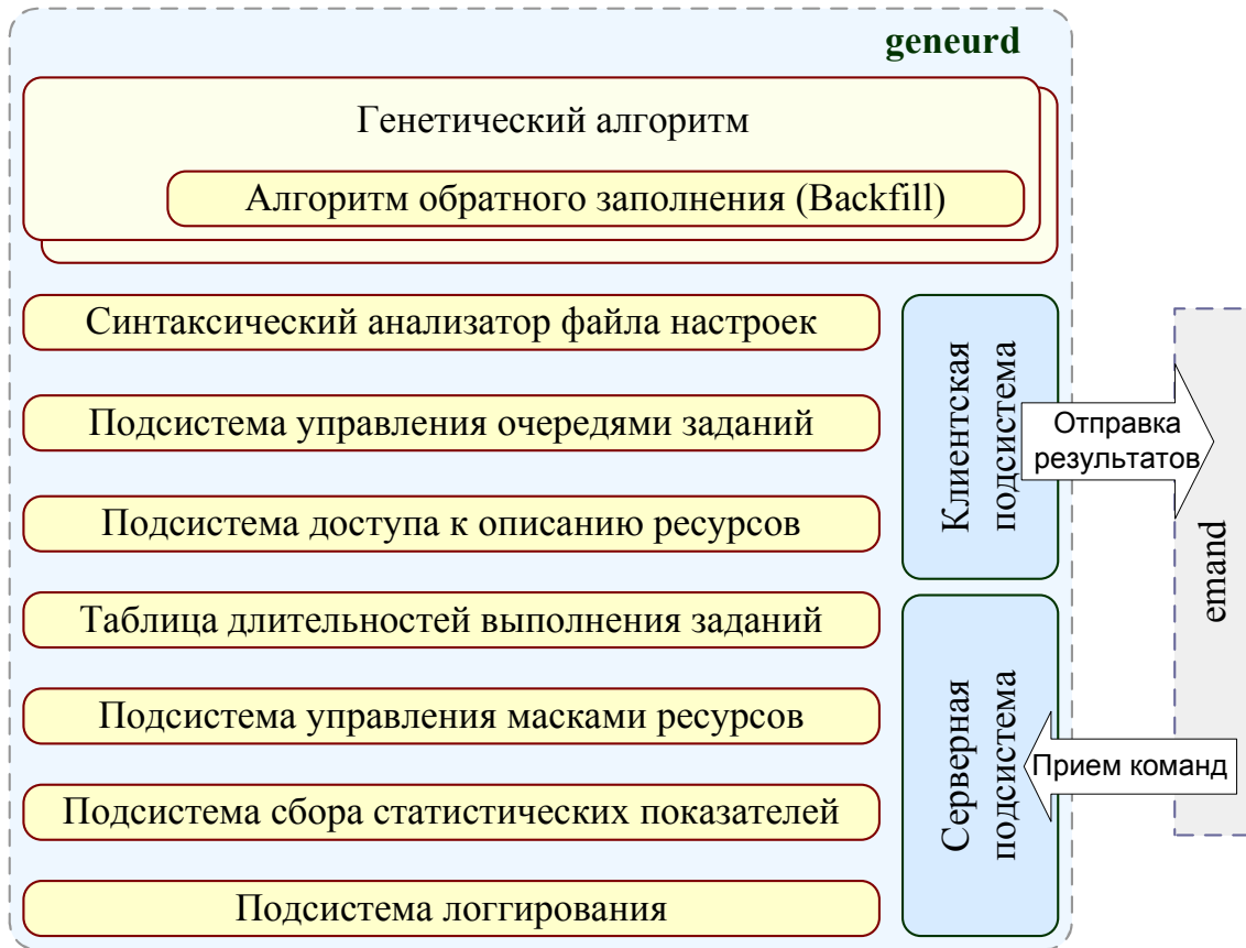
Рис. 3.4. Архитектура вычислительного модуля geneurd
